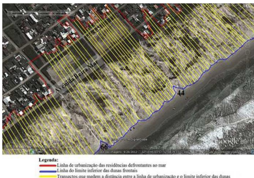
FIGURA 50. Imagem aérea de um trecho no norte do Balneário Cassino em 20/9/2012, destacando a distância entre a linha de urbanização e o limite inferior das dunas (linha de preamar marinha). Fonte: MÖLLER (2014).
