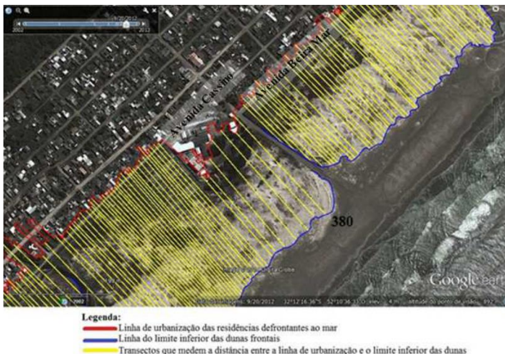
FIGURA 60. Imagem aérea do começo da localidade Atlântico Sul no Balneário Cassino em 20/9/2012, destacando a distância entre a linha de urbanização e o limite inferior das dunas (linha de preamar marinha). Fonte: MÖLLER (2014).
