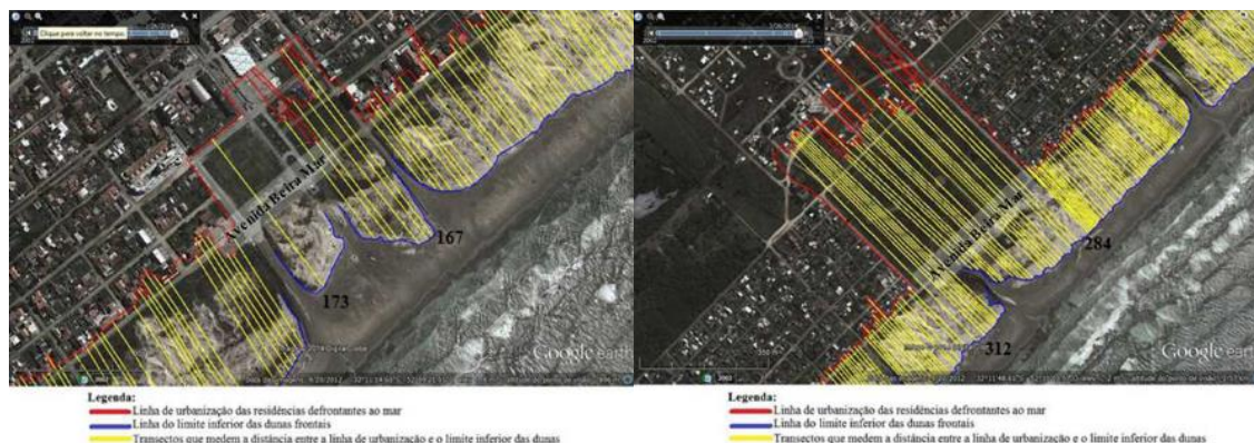
FIGURA 54. (a) Imagem aérea do final da Avenida Rio Grande (nas proximidades da estátua da Iemanjá), situada no Balneário Cassino em 20/9/2012, destacando a distância entre a linha de urbanização e o limite inferior das dunas (linha de preamar marinha); (b) Imagem aérea do campo pertencente ao Exército Brasileiro, próximo à localidade da Querência no Balneário Cassino em 20/9/2012, destacando a distância entre a linha de urbanização e o limite inferior das dunas (linha de preamar marinha). Fonte: MÖLLER (2014).
