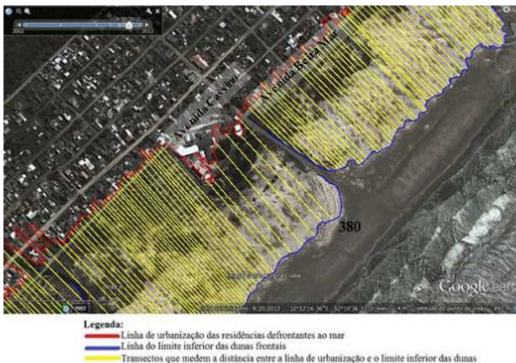
FIGURA 57. Imagem aérea do começo a localidade Atlântico Sul no Balneário Cassino em 20/9/2012, destacando a distância entre a linha de urbanização e o limite inferior das dunas (linha de preamar marinha). Fonte: MÖLLER, 2014.
